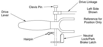
FIG. 11 DRIVE LEVER HARDWARE LOCATION
